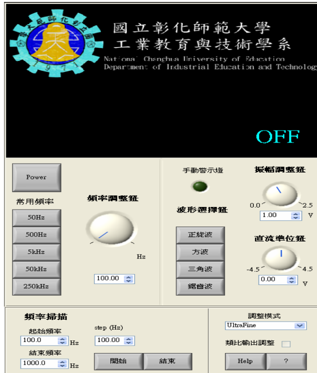
圖十: 虛擬信號產生器設計
