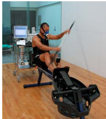
圖二 輕艇測功儀上進行攝氧峰值測試
